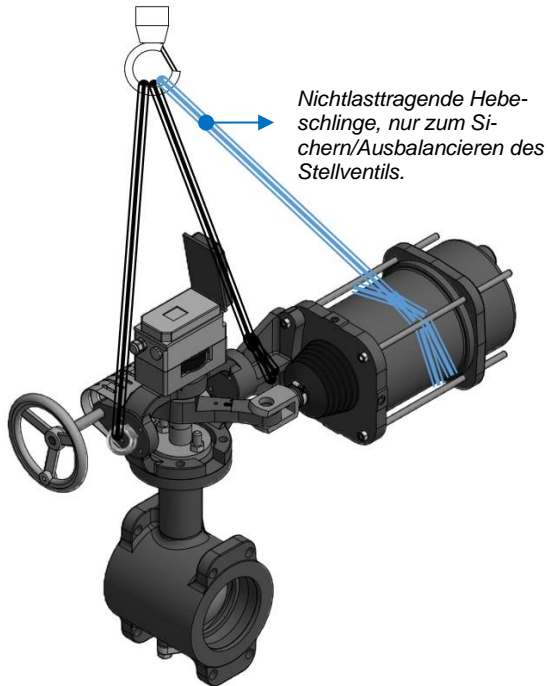
Bild 6.5: Hebepunkte - DKV Baureihe 72.4/R mit Handrad
