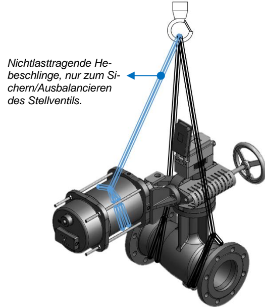
Bild 6.2: Hebepunkte - DKV Baureihe 72/R und 73/R mit Handrad
