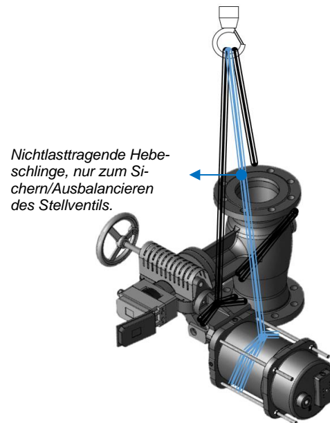
Bild 6.4: Hebepunkte - DKV Baureihe 72/R und 73/R mit Handrad
