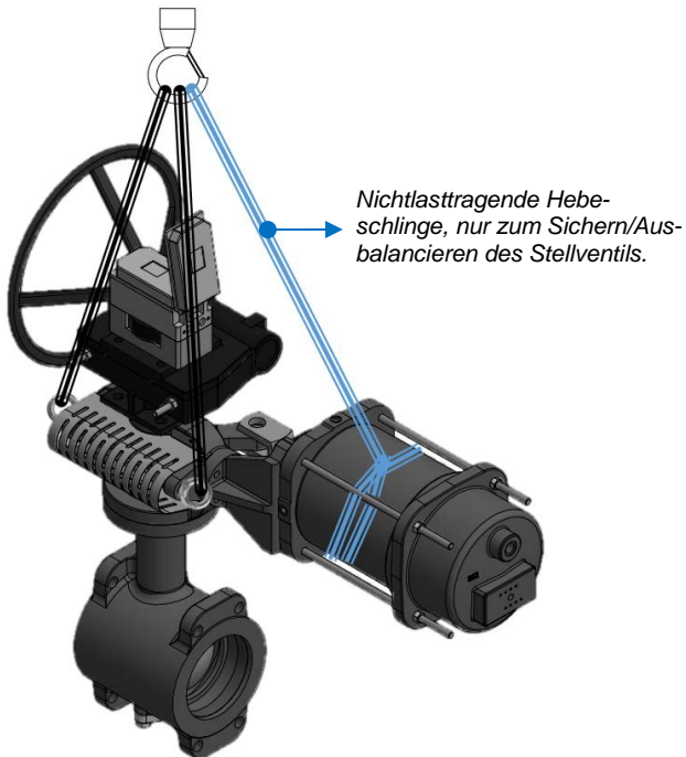
Bild 7.3: Hebepunkte - DKV Baureihe 72.4/R mit Handgetriebe
