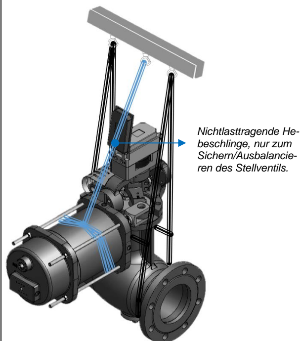
Bild 5.4: Hebepunkte - DKV Baureihe 72/R und 73/R
