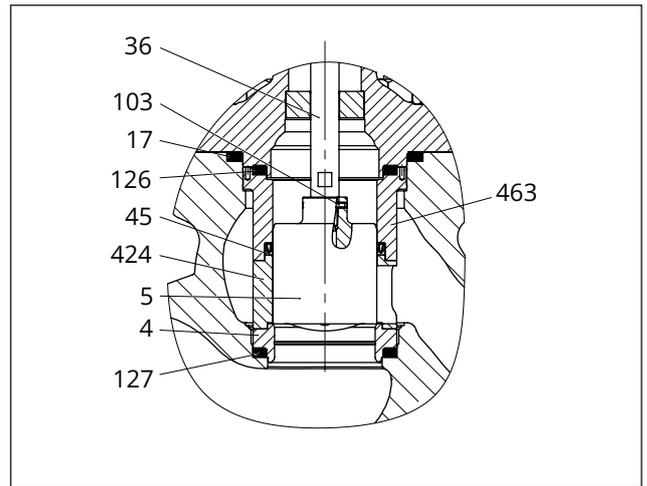
**Bild 13:** Variante der Garniturausführung: Käfig und Kolben
