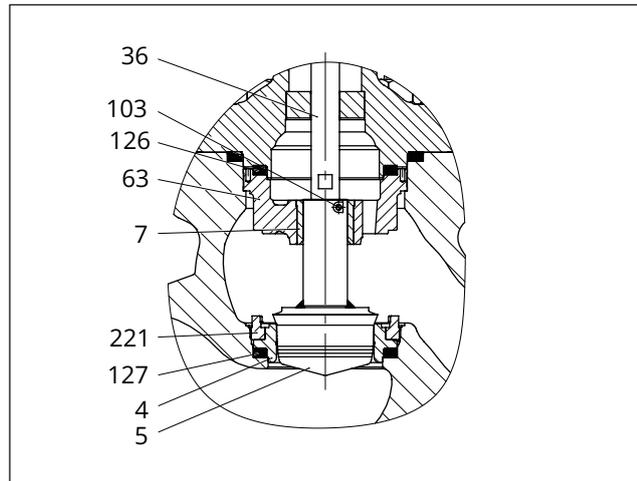
**Bild 7:** Variante der Garniturausführung: geschraubter Sitz und Kegel
