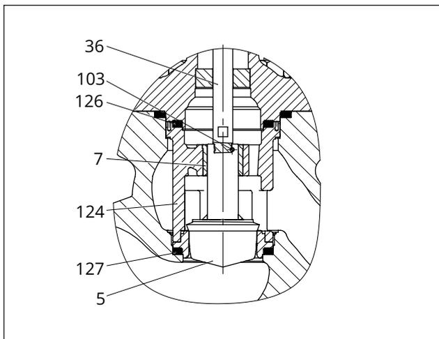
**Bild 11:** Variante der Garniturausführung: geklemmter Sitz und Kegel
