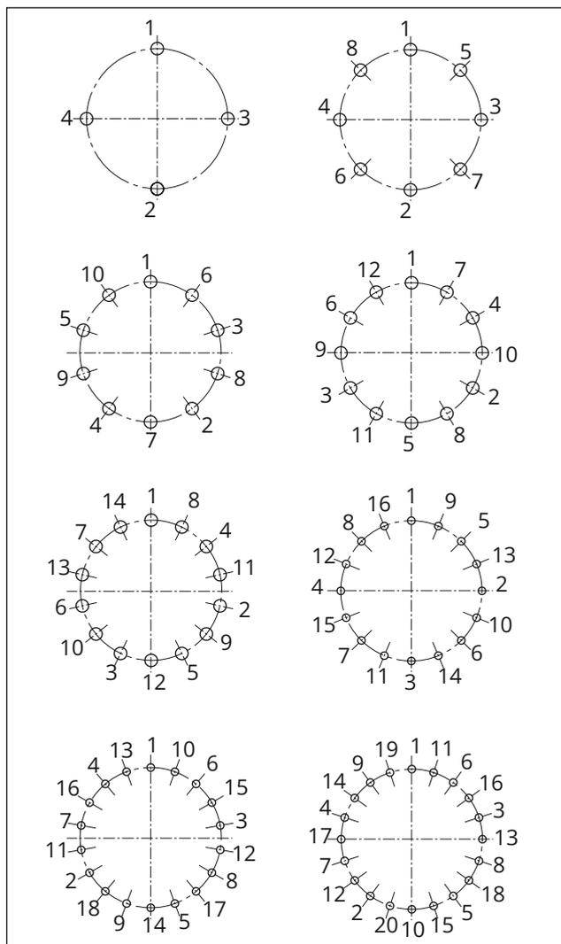
**Bild 37:** Anzugsreihenfolge bei 4, 8, 10, 12, 14, 16, 18 und 20 Verschraubungen
