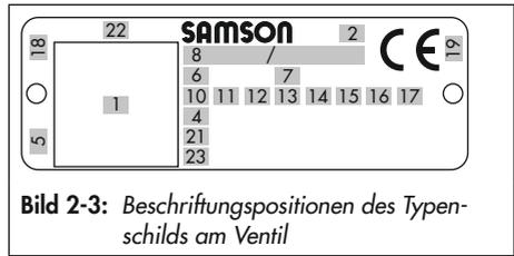
**Bild 2-3:** Beschriftungspositionen des Typenschildes am Ventil
