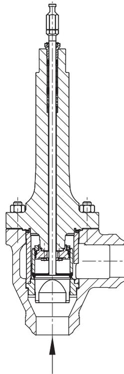
**Bild 3:** Typ 3296 mit Anschweißenden und Isolierteil
