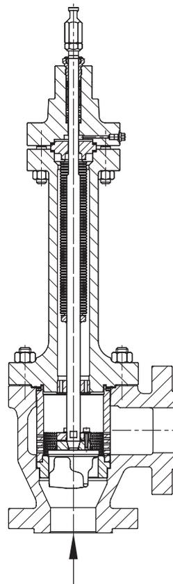
**Bild 4:** Ventil Typ 3296 mit Metallbalgabdichtung
